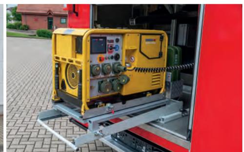
• Heckansicht GR mit DIN Auszug für **Stromerzeuger**. • **Stromerzeuger**, herausgezogen.
