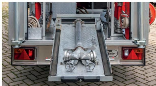
• Lagerungsschlitten TS mit Standrohrhalterung.
