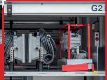
• Rechte Aufbauseite G2, Rolläden mit Drehstangenverschluss abschließbar.
