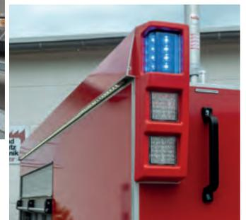
• LED Heckblaulicht, LED Blinker, Stand- und Bremslicht, LED Umfeldbeleuchtung.
